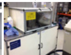
Testopstelling voor pulsdruk tot 4000 bar
